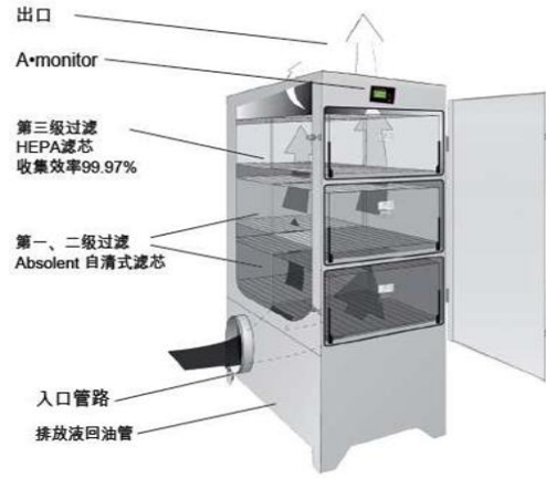
图 4-3 装配车间油雾废气处理设施
